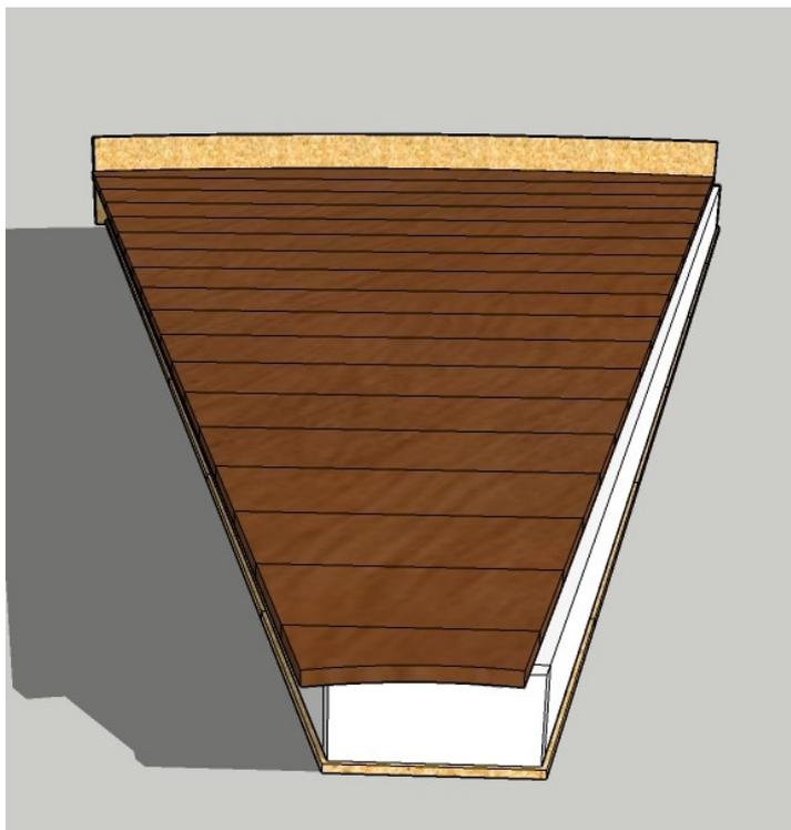
Avant de découper le plancher, vérifiez que votre gabarit est bien placé. Le plancher doit être découpé 20mm rentrant par rapport à la structure du côté des lattes de décalage et sortant de 40mm de l'autre côté.
